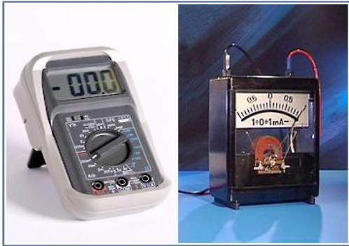
Obr.6.Simulácia č.4: Merače elektrického prúdu
