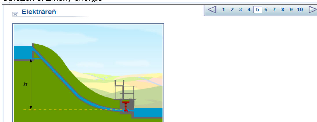
Obrázok 7: Prečerpávanie vody do vyšších polôh vo vodných elektrárňach.
